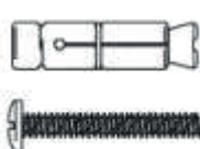
ANKERDÜBEL AUS METALL
